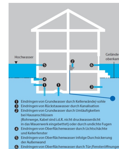
Wassereintrittsmöglichkeiten bei Gebäuden
